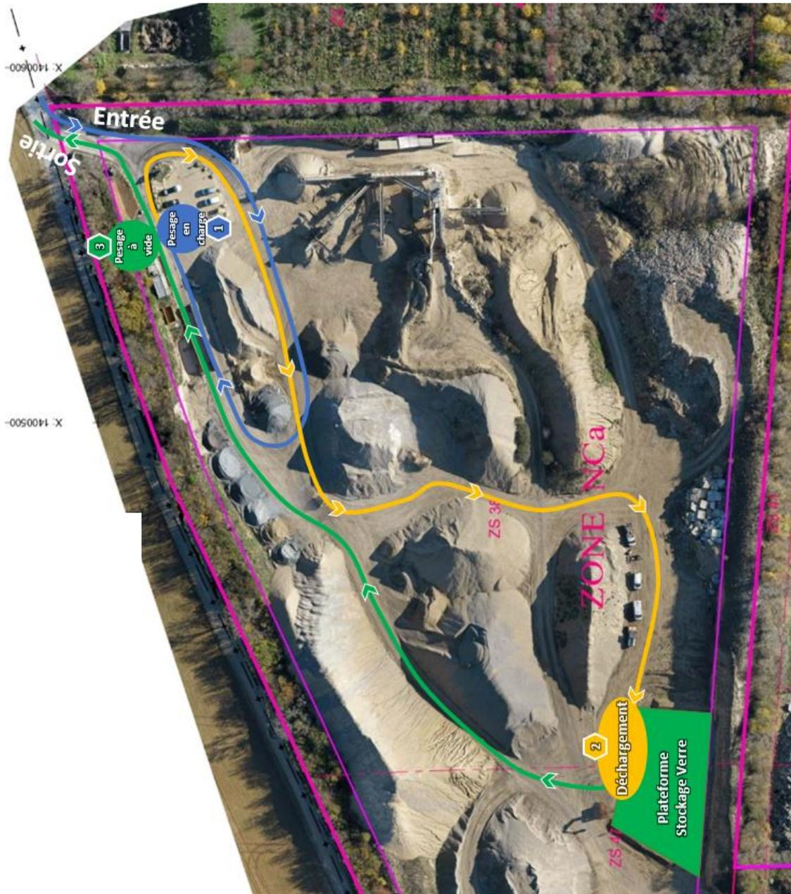
Figure 29 : Plan de circulation de la plateforme de verre
